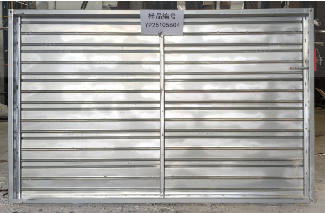
照片 2 耐火性能试验结束后试件情况
